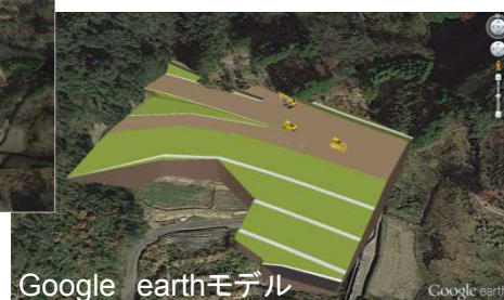
3次元設計データを自社で作成するため、LandXMLデータを誰もが利用可能なSKP(スケッチアップ)やGoogle earthモデルに変換し、発注者や下請業者との打合せに利用してる。
