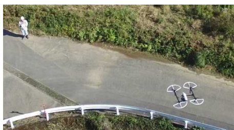
自社所有のUAV(DJI Inspire)による起工測量を行い、3次元モデルを作成。
