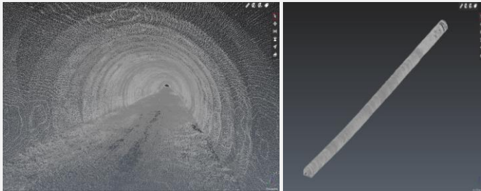
[ 차량에 3D 스캐너 탑재하여 터널 내부 스캔 ]
